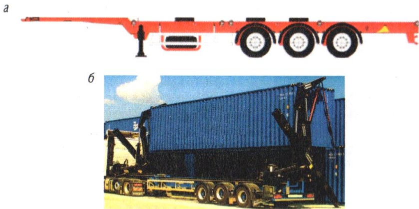
Рис. 1.10.2. Транспортные средства, применяемые при автомобильной перевозке контейнеров: а – полуприцеп-контейнеровоз; б – полуприцеп-самопогрузчик для перевозки контейнеров
